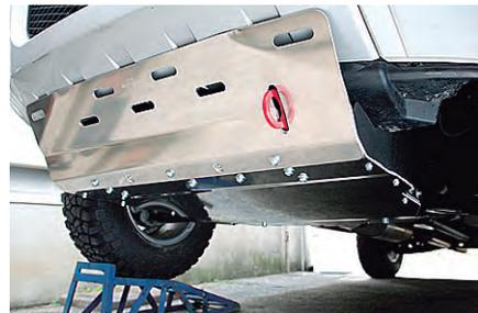
ウォーカーサプライズ製4インチアップメンバーダウンキット専用。両サイドに泥混入防止用樹脂製のカバー付き。ジュラルミン製5mm厚。けん引フック(スチール赤)1ヶ付き。スキッドプレートはアルマイト仕上げ(写真はアルマイト加工前)。2インチアップ、6インチアップ用追加発売予定。
