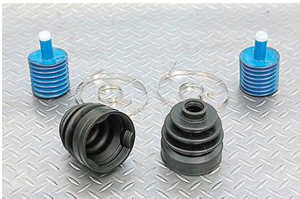
リフトアップ車用。ドライブシャフトに角度が付いた状態で、こすれにくいように山ピッチをずらして製作。少し長く、こすれに強い材料を使用。フロントインナー側用。グリス付き。
