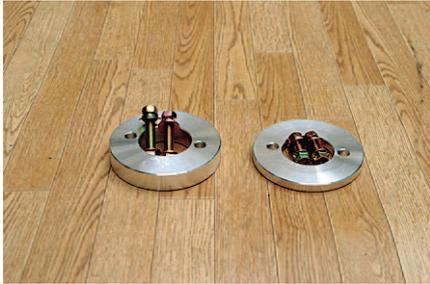
前後左右の傾き調整に使用。スプリングシートとホーシングの間に取り付け。アルミ合金製。ディフェンダー、クラシックレンジ、ディスカバリーシリーズ、2ndレンジ(コイルコンバージョン済)用。
